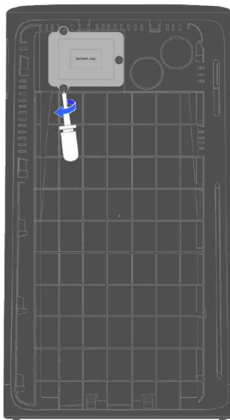
4. Soulevez soigneusement le circuit imprimé pour exposer le câble d'alimentation en dessous. Appuyez sur le loquet blanc et retirez le câble.
