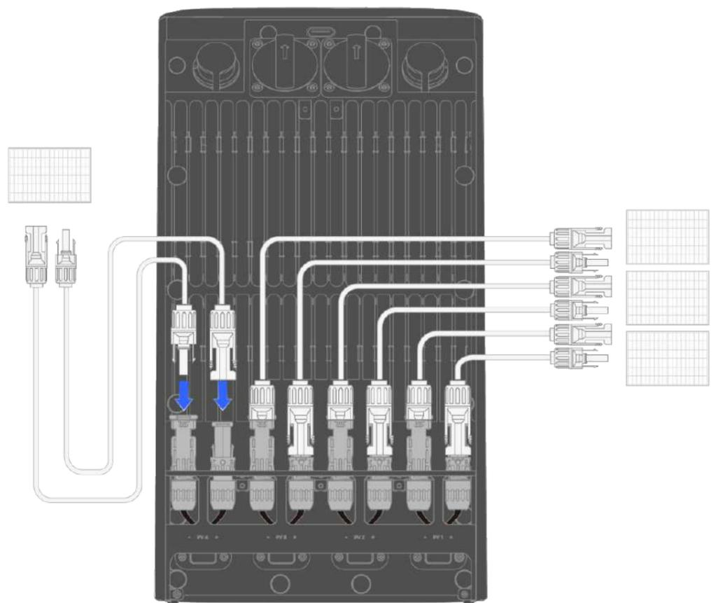
⚠ Lorsque vous connectez des panneaux solaires, assurez-vous que les fils positifs et négatifs d'un seul panneau sont connectés à la même paire de bornes PV (par exemple, PV1+ et PV1-). Ne connectez pas les fils sur différentes paires de bornes (par exemple, positif à PV2+ et négatif à PV1-), car cela pourrait provoquer un court-circuit.
