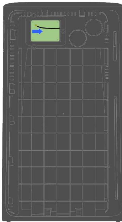
6. Connectez les câbles d'alimentation et de signal au nouveau module IoT, et placez-les dans la bonne position (évitiez de pincer les câbles).
