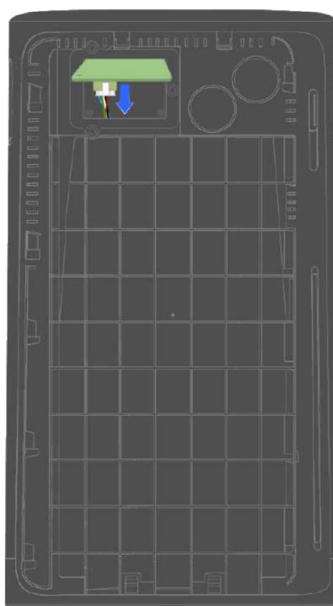
5. Sortez le câble de signal directement du circuit imprimé pour retirer complètement l'ancien module IoT.
