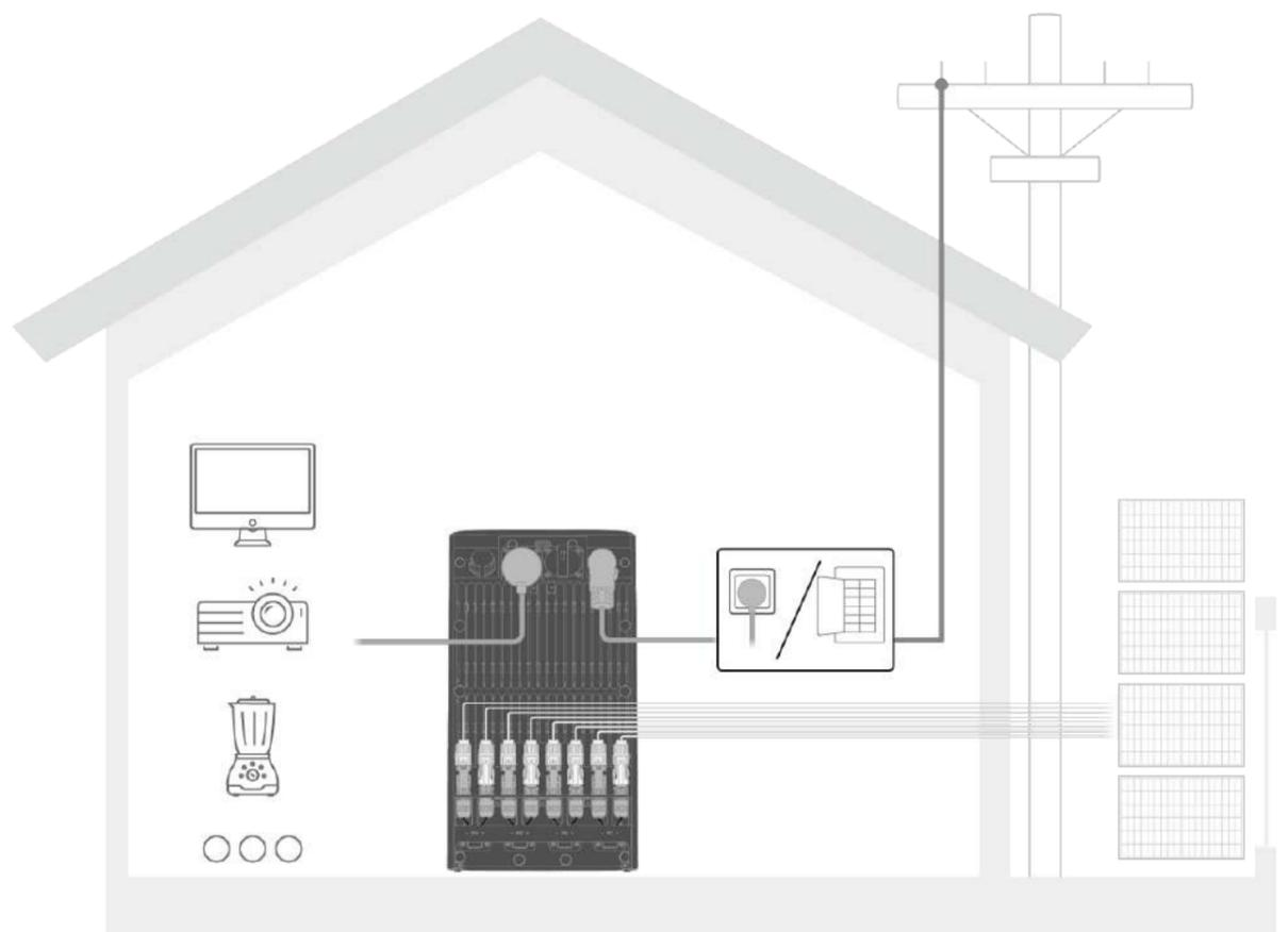
**i** Le temps de commutation de l'alimentation de secours varie en fonction de l'efficacité de l'énergie solaire et de l'état de la batterie, et peut prendre jusqu'à 3 secondes. Ne connectez pas d'appareils qui nécessitent une commutation d'alimentation sans coupure, car cet appareil n'est pas conçu pour fonctionner comme une alimentation sans coupure (ASI).
